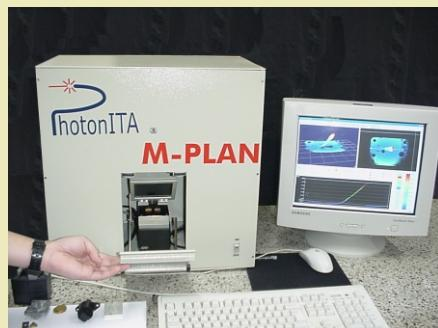
Aquisição e processamento das franjas de shadow Moiré
