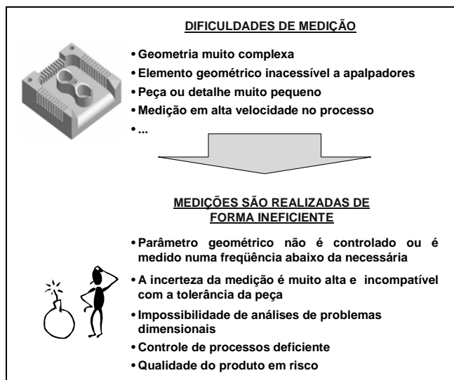
Figura 2 – Dificuldades no controle dimensional de componentes complexos de pequenas dimensões
