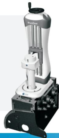
O BruniTest é um sistema inovador para a avaliação da qualidade de superfícies brunidas. Possui a capacidade de inspecionar de forma rápida e automatizada o interior de cilindros brunidos e medir automaticamente parâmetros do processo, como ângulos entre riscos do brunimento, distâncias entre riscos, rugosidade, etc.
